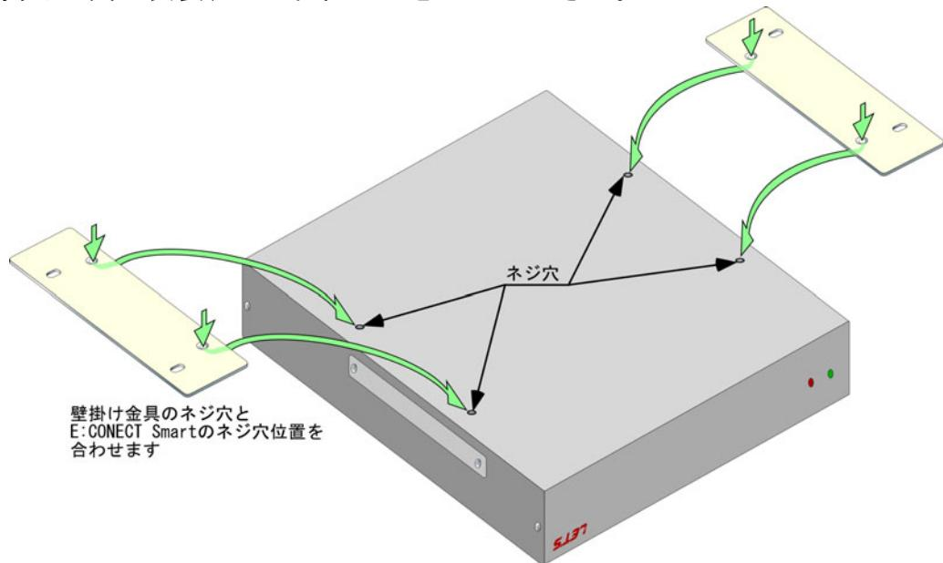
④ネジの位置、壁掛け金具の表裏を正しく合わせたら、本体にネジ留めします。
