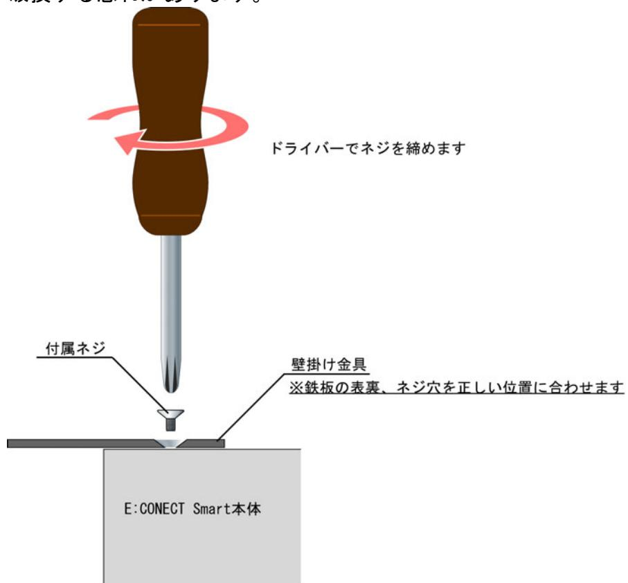
⑤壁面の適切な位置に固定します。
