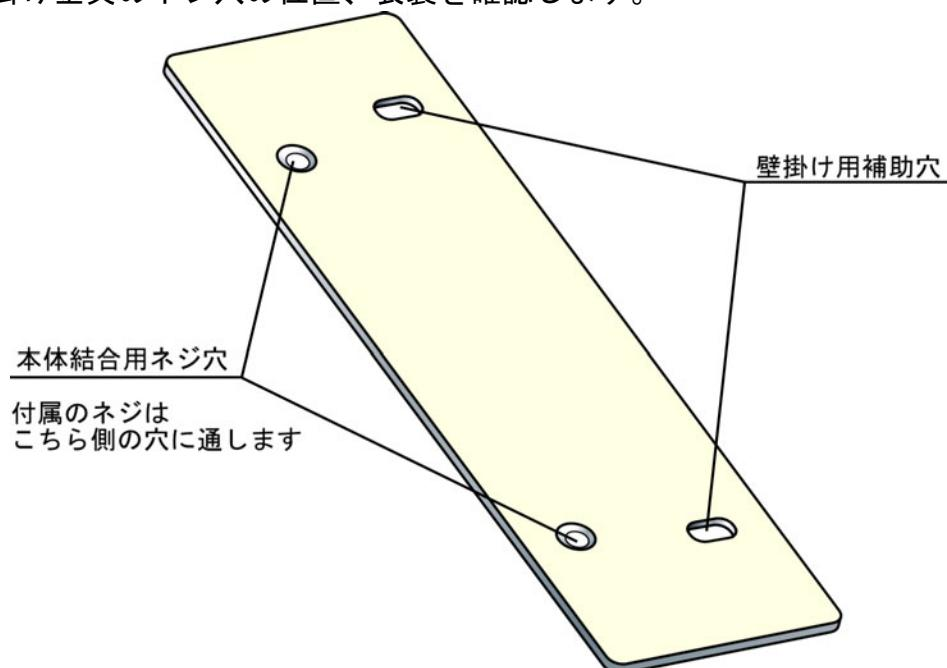
③壁掛け金具をE:CONNECT Smart底面にネジ留めします。
