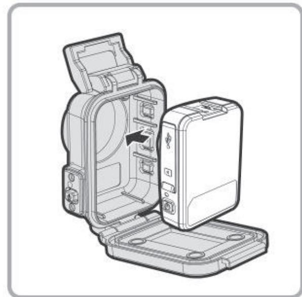
2. バックルの輪をケースの上部に持ち上げ、機器が前面ケースにしっかりと取り付けられていることを確認し、続いて背面カバーを閉じます。
