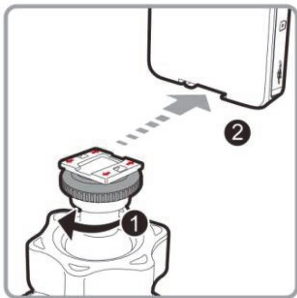
2. ノブを締め付け、機器がしっかりと固定されていることを確認します。
