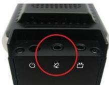
外付けGPSモジュールを接続し、衛星電波を受信して位置情報確認ができます。GPSの設置は左図の通り連結します。
