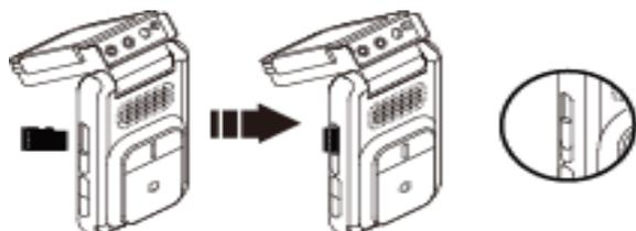
弊社ドライブレコーダーは、Micro SDカードをドライブレコーダー本体に挿入した後、車と本体を接続する方法を推奨しています。
