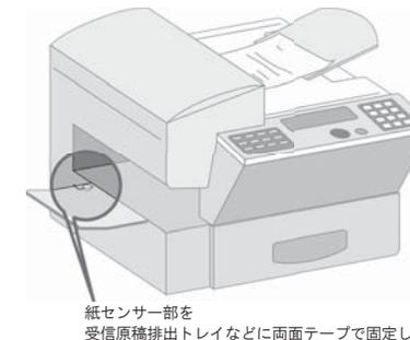
紙センサーの先端部を、受信原稿の排出部に正対するように取り付けてください。
