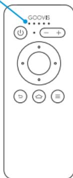
終了する場合は、電源ボタンを3秒間長押しするとバッテリーインジケータランプが消灯し、コントローラー電源を消すことができます。電源ボタンを12秒長押しすると、コントローラーをリセットすることができます。
