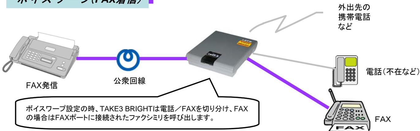
ボイスワープ設定の時、TAKE3 BRIGHTは電話/FAXを切り分け、FAXの場合はFAXポートに接続されたファクシミリを呼び出します。
