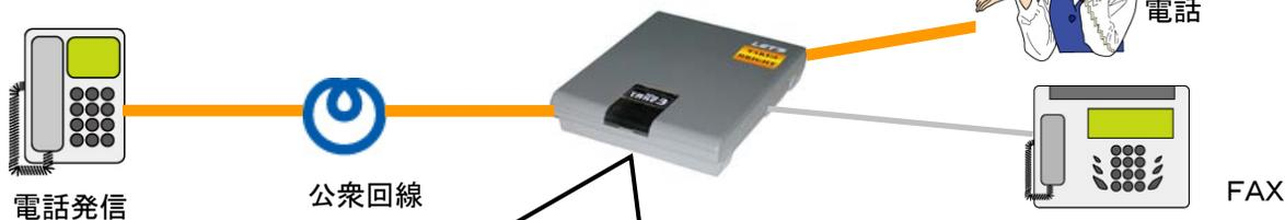
電話の着信の場合、TELポートに接続された電話を呼び出します。
