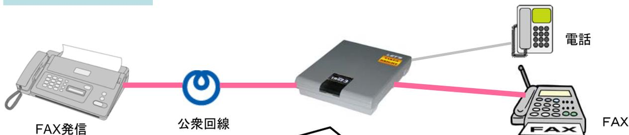
FAXの着信の場合、FAXポートに接続されたファクシミリを呼び出します。
