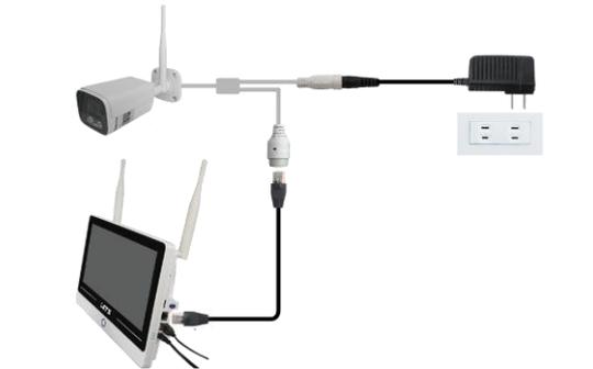
1. 追加のカメラに、電源アダプタを接続し、電源を入れます。まだ、設置をしないでください。
