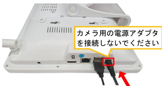
6. 録画装置の電源アダプタ (DC12V/3A) を接続します。録画装置の電源が入ります。
