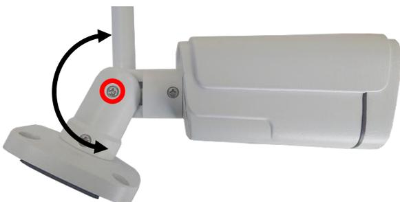
10. 脚の角度を調整後、左図のネジを締めて、脚を固定します。
