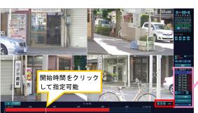
③ 再生ファイルを選択し、「ファイル再生]を クリックすると、再生を開始します。 または、下側のバーから時間帯を選択し、 [▶]をクリックして再生します。
