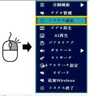
① ライブ映像画面で右クリック してメニューを表示させ、[シ ステム設定]をクリックしま す。設定画面が表示されます。
