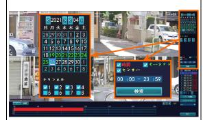
② 再生日、チャンネル、録画モード、及び再生時 間帯を選択し、[検索]クリックします。 録画ファイルが、下表に表示されます。 また、録画した時間帯がバー表示されます。
