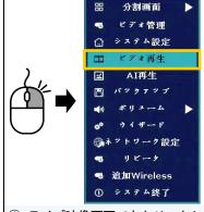
① ライブ映像画面で右クリックし てメニューを表示させ、[ビデオ 再生]をクリックします。ビデオ 再生画面が表示されます。
