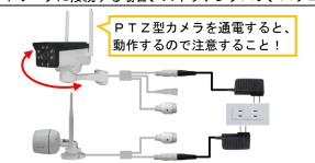
① カメラを設置し、カメラ用電源アダプタを接続します。
