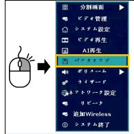
① USBメモリを接続後、ライブ映像 画面で右クリックしてメニュー を表示させ、[バックアップ]を クリックします。バックアップ 画面が表示されます。
