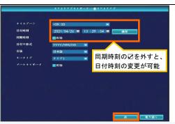
☑を外してから日付時刻を合わせ、[適用] をクリックしてから[次]をクリックします
