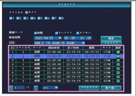
③ バックアップするファイルの右側に**ノ**をつけて 選択し、[バックアップ]をクリックすると、バッ クアップを開始します。
