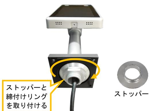
4. 上面カバーの穴に、本体の軸を通します。その後、付属のストッパーを、上面カバーに取り付けてから、締付けリングを本体の軸部に取り付けて固定します。
